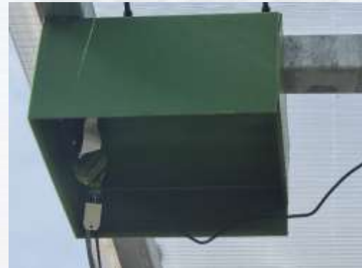
Vnější měřicí box: Teplota, vlhkost, vlhkost půdy, výška růstu a kamera
