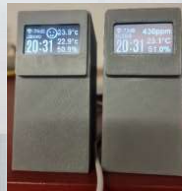
Domácí měření s displejem: Teplota, vlhkost, CO 2
