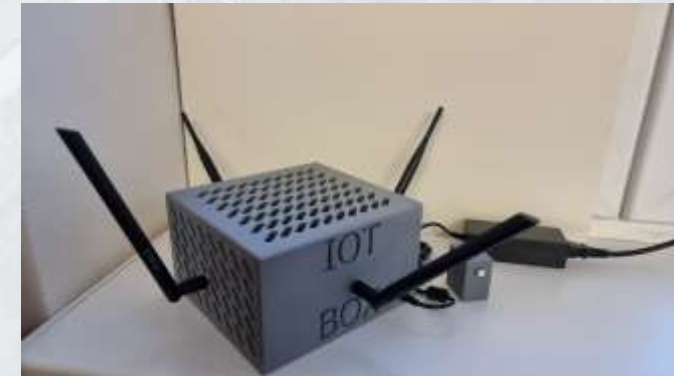
IoT Box: GSM modem, Wi-Fi Router, další bezdrátové připojení pro zařízení IoT, hlavní řídicí jednotka
