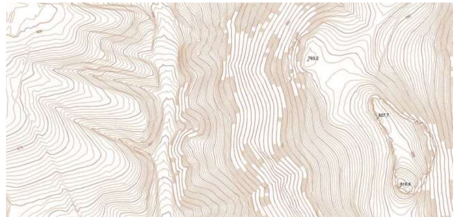
NOVÉ VRSTEVNICE – EKVIDISTANCE 1m
