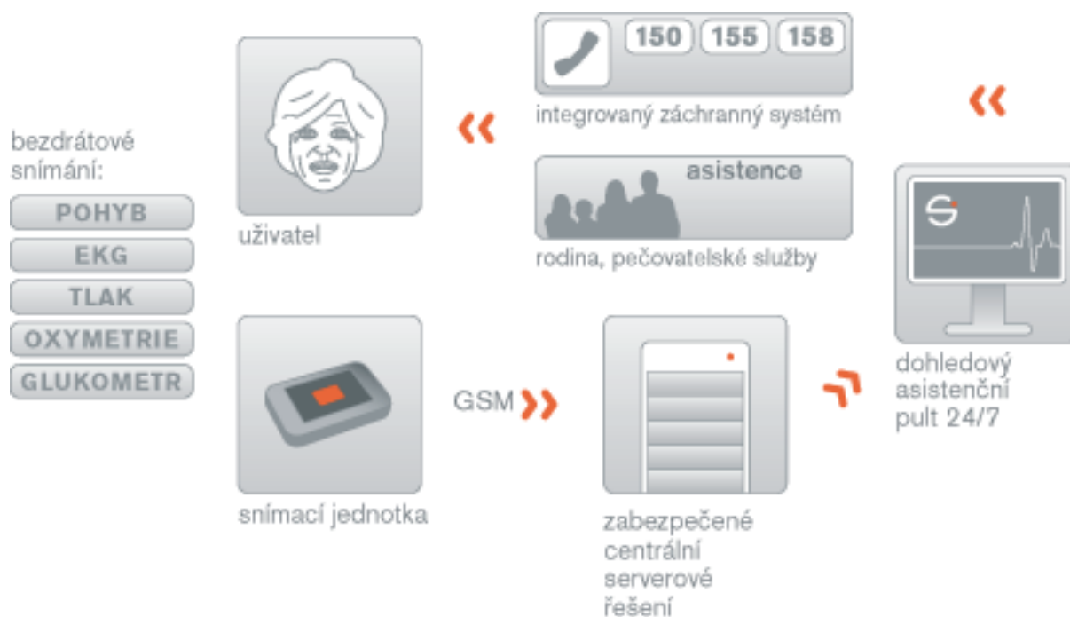
Obr. 4. Princip funkce systému SeniorInspect
