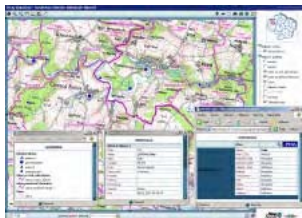
Mapový projekt turistického portálu kraje Vysočina, běžecké tratě v okolí Nového Města na Moravě – ArcIMS 9.0, ArcSDE 9.0 na Oracle 9i, vlastní mapový klient. Průběh tras na základě sběru GPS dat z roľby. Zpětné poskytování dat přes WMS pro mapový server NMNM
