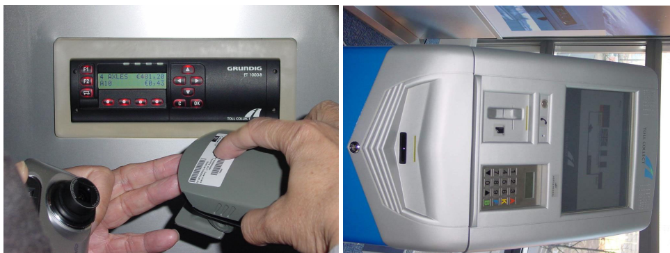
Obr. 5. Ukázka vozidlové jednotky a ručního zadávacího systému GSM/GPS
